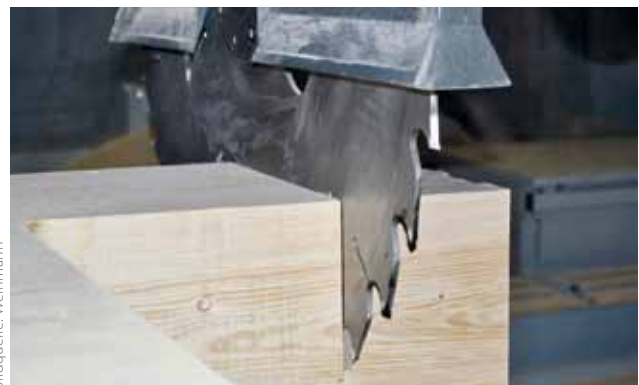
Werkstückdicken bis zu 600 mm können bearbeitet werden
